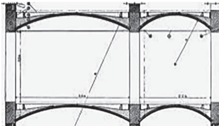
Bóvedas de revoltón
